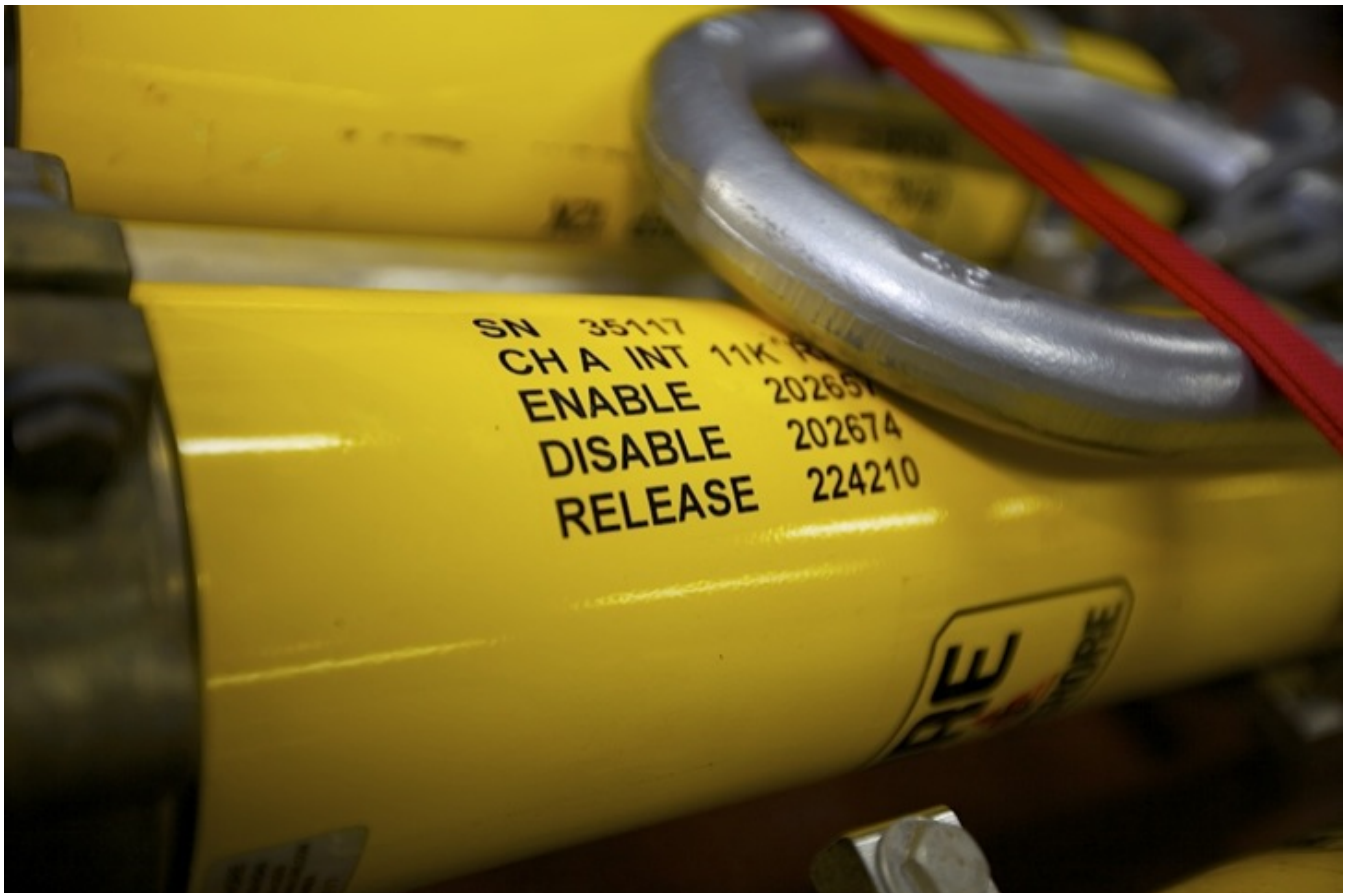
Om et års tid vil forhåpentligvis denne utløseren slippe taket i ankeret når den pinges med kode 224210. Foto: Sindre Skrede
