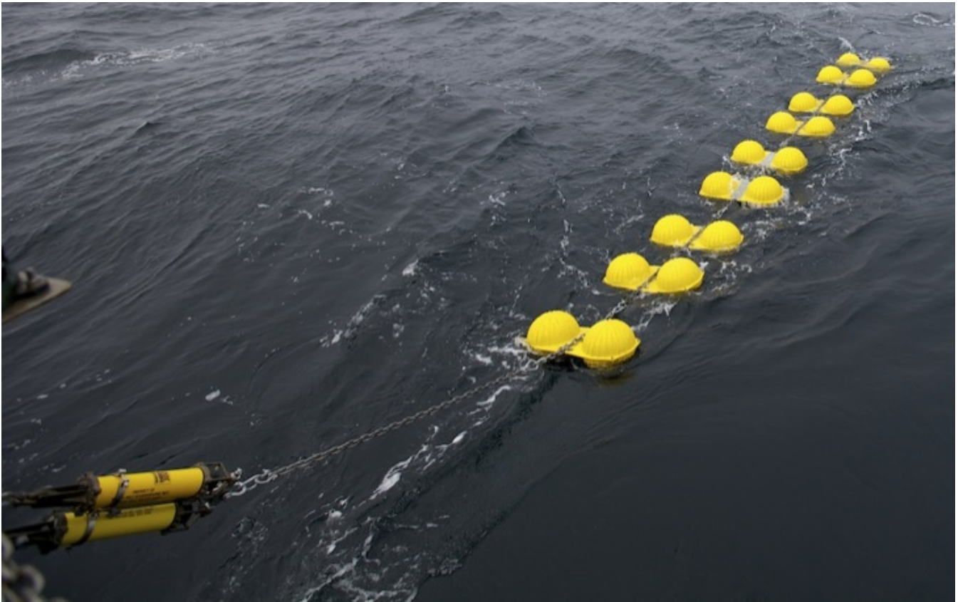
Akustiske utløsere og "hard hats" - sistnevnte er glasskuler dekket av hardplast. Foto: Sindre Skrede
