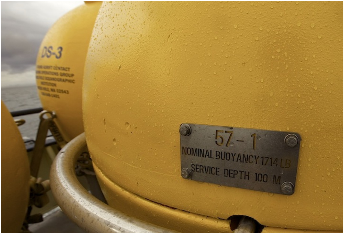
WHOI-bøye, 780 kg oppdrift, 100 meter arbeidsdybde. Foto: Sindre Skrede
