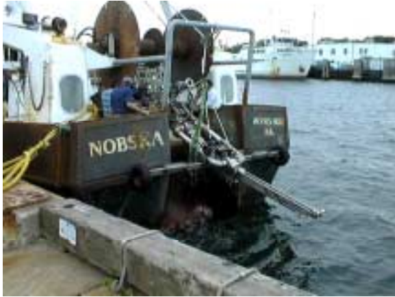
Fig. 4 Trencher aboard F/V Nobska
